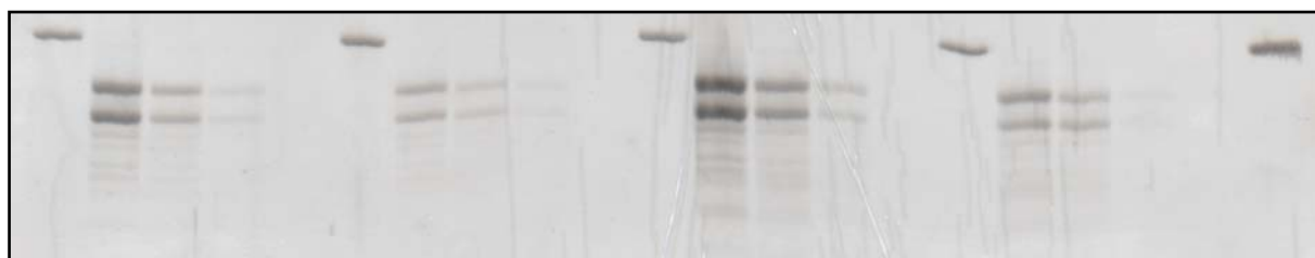
12.a. ábra PEZ20 lókusz monoplex vizsgálatának optimalizálása
